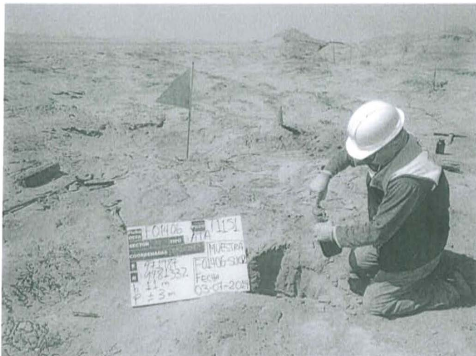
Fotografía N° 2. Toma de muestra de suelo en el punto F01406-SU02, ubicado a 2,50 m de distancia del Casing, Pozo T 1151.
