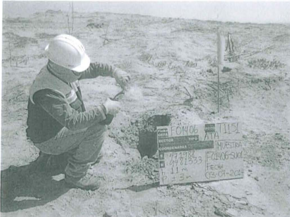
Fotografía N° 1. Toma de muestra de suelo en el punto F01406-SU01, ubicado a 1,50 m de distancia del Casing, Pozo T 1151.
