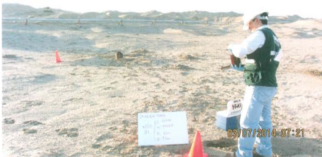
Fotografía N° 3. Toma de muestra de suelo en el punto F01401-SU01, ubicado a 8,2 m aproximadamente del Pozo T1150.
