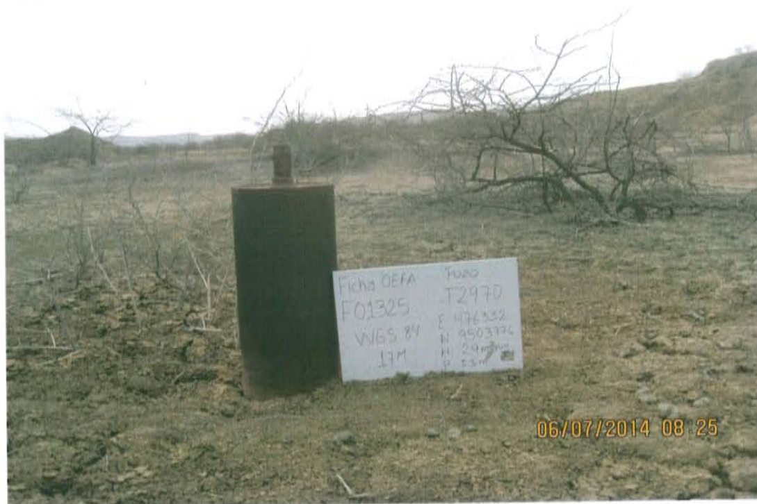
Fotografía N° 1. Identificación del pozo inactivo con código PERUPETRO T2970. Presenta casign con concreto en su interior y tubo abierto en la parte superior.
