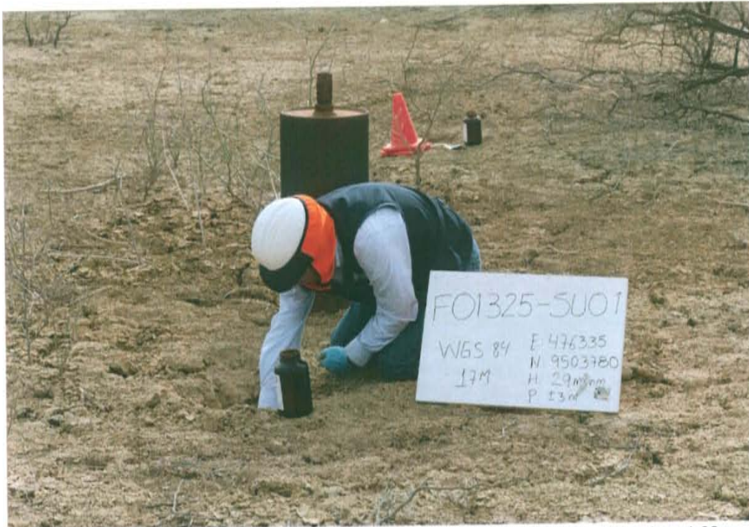
Fotografía N° 3. Toma de muestra de suelo en el punto F01325-SU01, ubicado a 1,32 m aproximadamente al suroeste del Pozo T2970.
