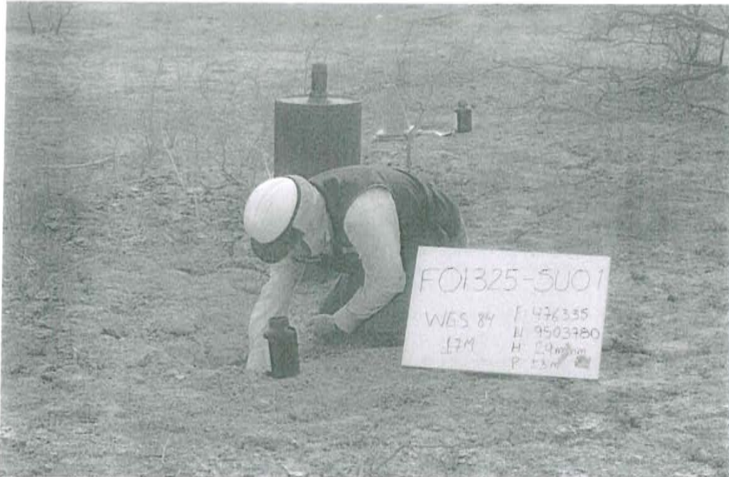
Fotografía N° 1. Toma de muestra de suelo en el punto F01325-SU01, ubicado a 1,32 m aproximadamente al suroeste del Pozo T2970.
