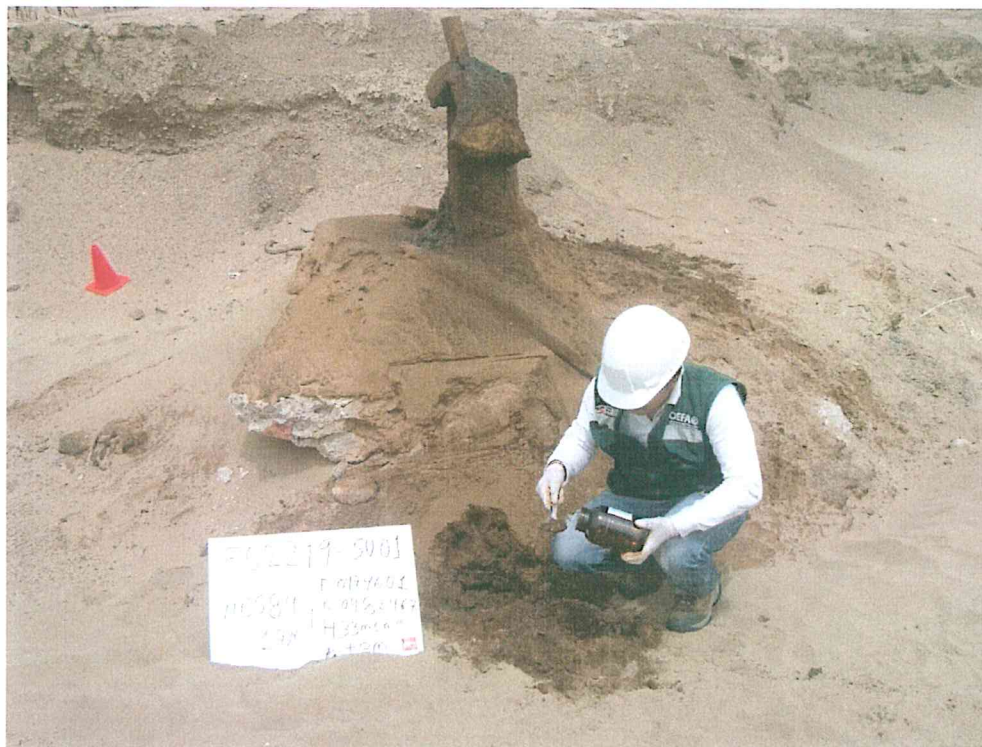
Fotografía N° 3. Toma de muestra de suelo en el punto F02219-SU01, ubicado a 1,5 m aproximadamente del Pozo T3891.
