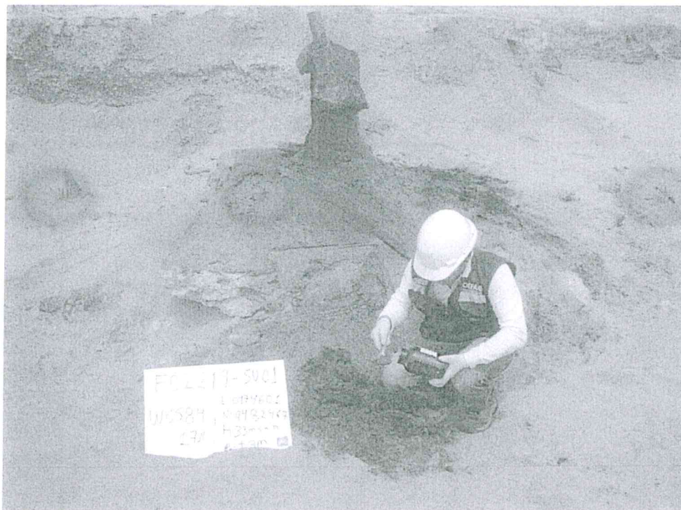
Fotografía N° 1. Toma de muestra de suelo en el punto F02219-SU01, ubicado a 1,5 m aproximadamente del Pozo T3891.
