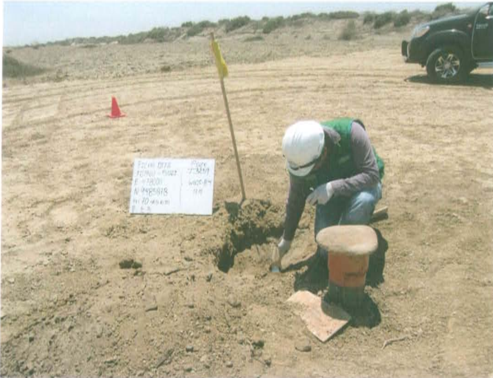
Fotografía N° 3. Toma de muestra de suelo en el punto F01960 -SU01, ubicado a 0,5 m en dirección norte del Pozo T3259.
