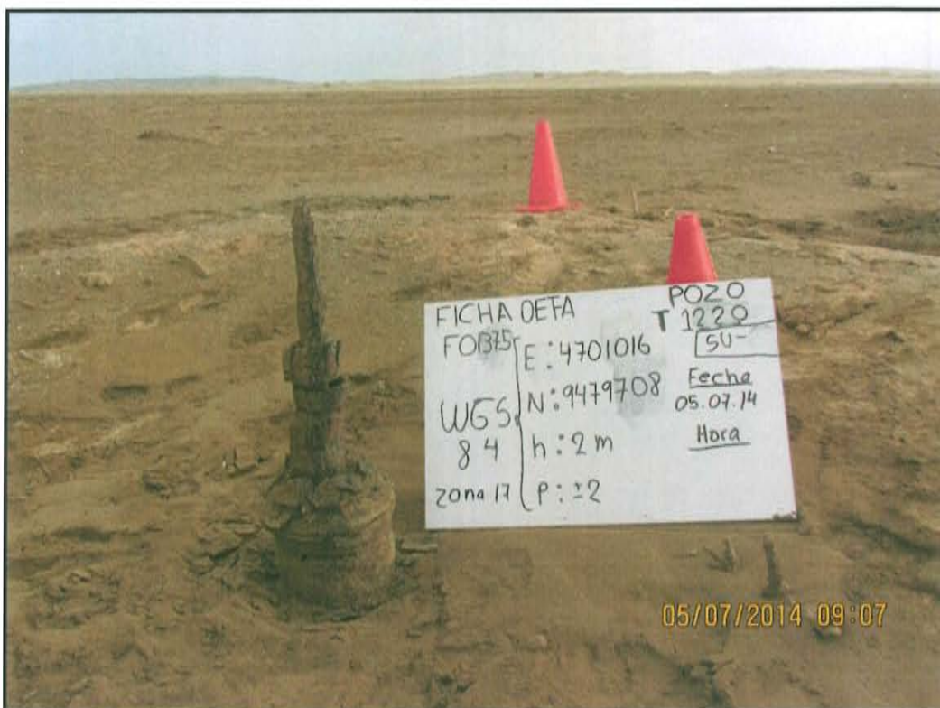
Fotografía N° 2. Se observa el cabezal de pozo T1220 que emerge a una altura de 0,6 m desde la superficie del suelo.
