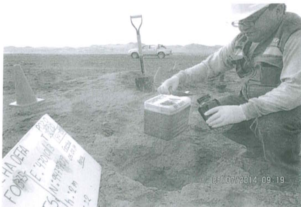
Fotografía N° 2. Toma de muestra de suelo en el punto F01375-SU02, ubicado a 3,2 m aproximadamente del Pozo T1220.
