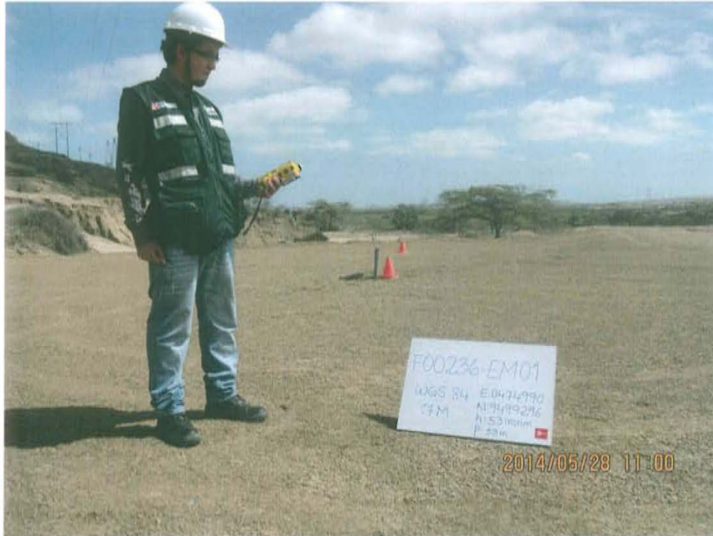
Fotografía N° 5. Medición de emisiones gaseosas fugitivas en el punto F00236-EM01, ubicado a 7 m de distancia de la fuente de emisión del Pozo T3266.
