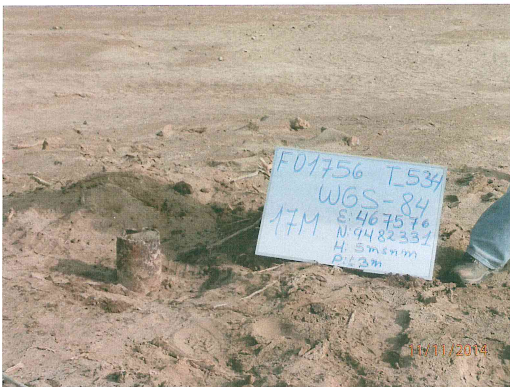
Fotografía N° 1. Se observa el casing corroído que se sobresale a la superficie del suelo.
