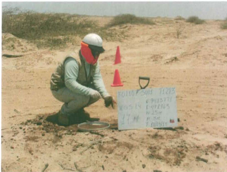
Fotografía N° 4. Toma de muestra de suelos, se aprecia presencia de hidrocarburos.
