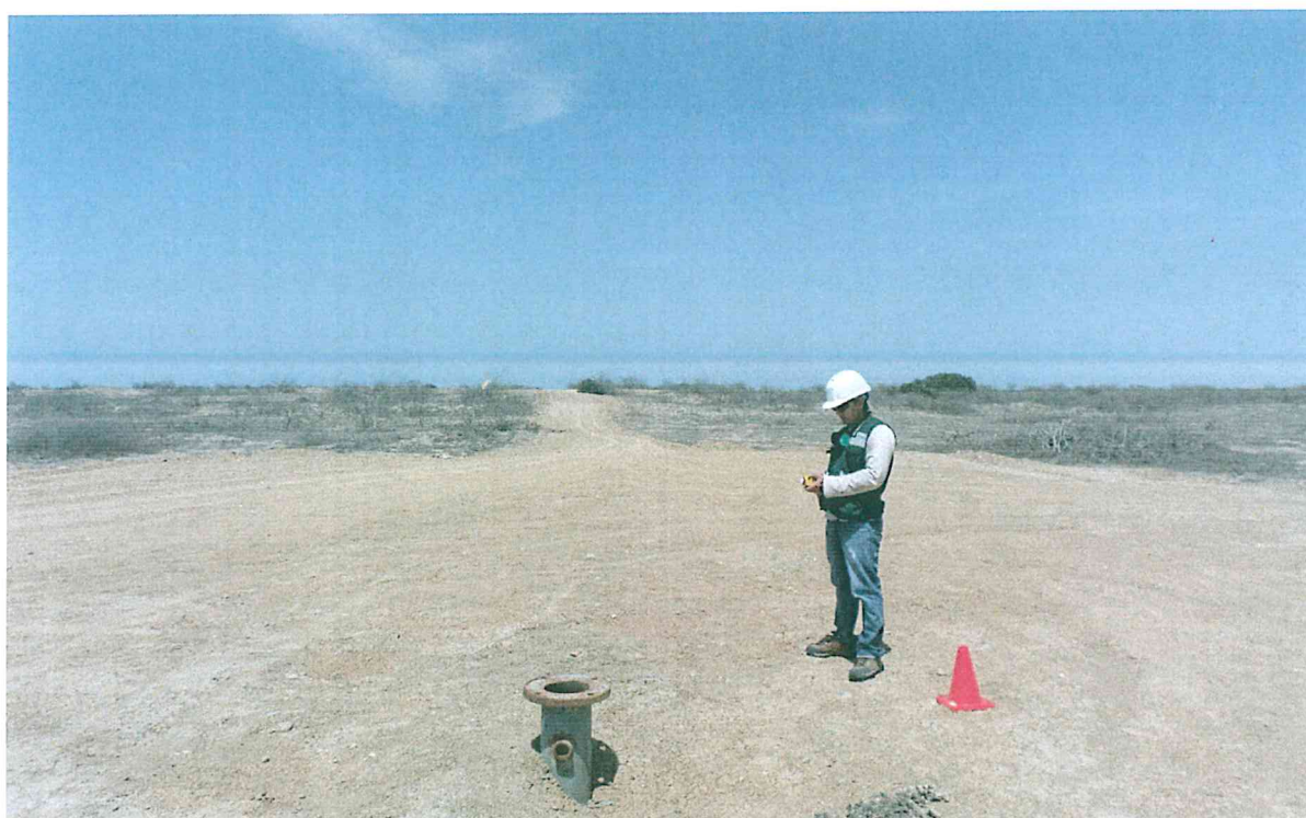
Fotografía N° 6. Mediciones en el punto F02768-VA01, se realizó un recorrido en el área circundante alrededor del pozo T2919, en un radio de 1 m aproximadamente y con una duración de 10 minutos.
