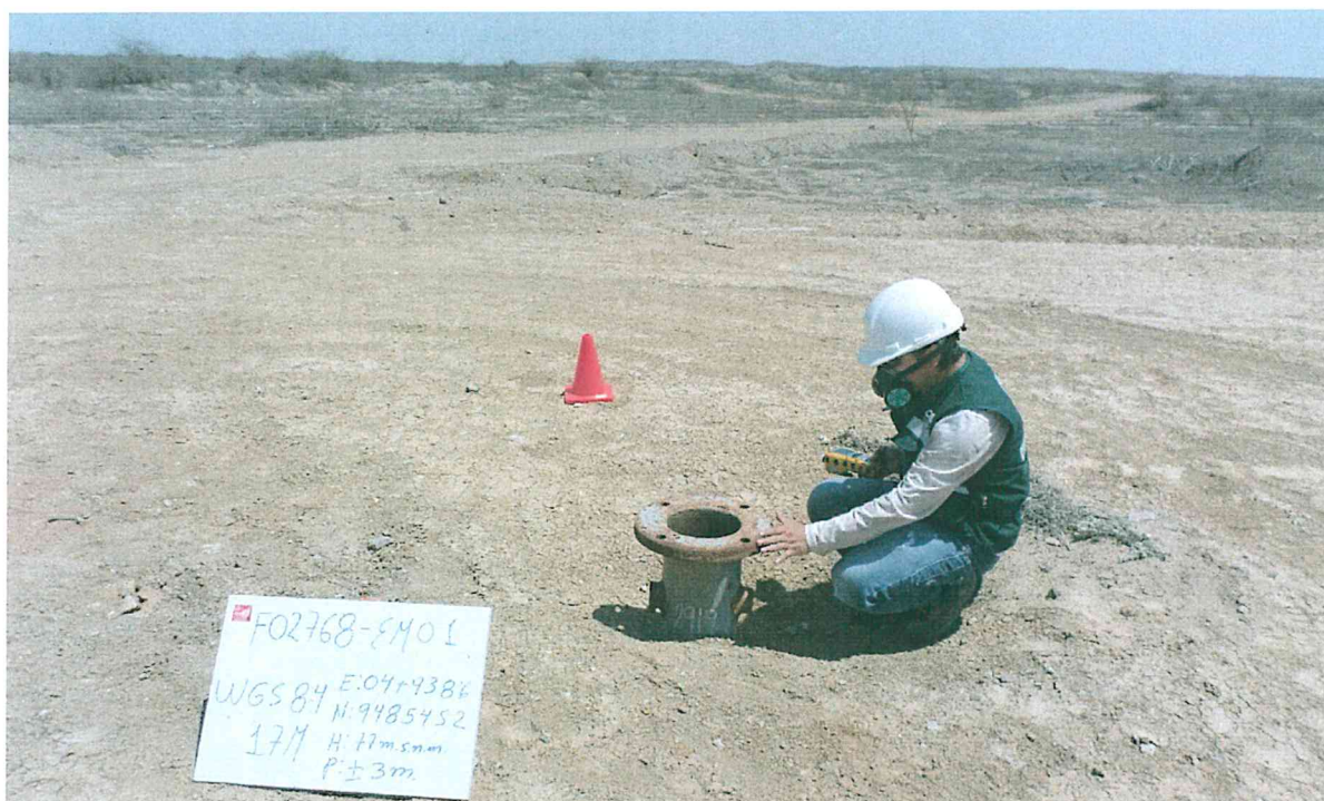
Fotografía N° 5. Medición en el punto F02768-EM01, ubicado en la fuente de emisión en boca del pozo T2919.
