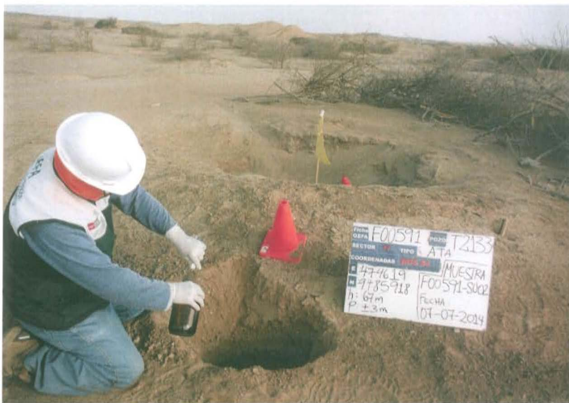
Fotografía N° 03.- Toma de muestra de suelo en el punto F00591-SU01, ubicado a 0,5 m aproximadamente del pozo T2133.
