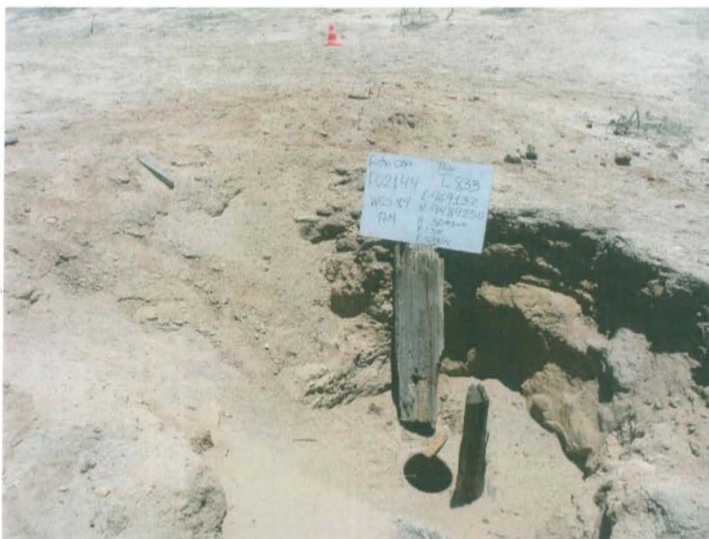
Fotografía N° 1. Se observa casing corroído a nivel de la superficie del suelo en el interior de un hoyo y se encuentra abierto al ambiente.
