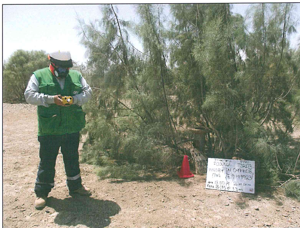
Fotografía N° 6. Mediciones en el punto F03010-VA01 alrededor del pozo T3203, en un radio de 1 m de distancia y con una duración de 5 minutos
