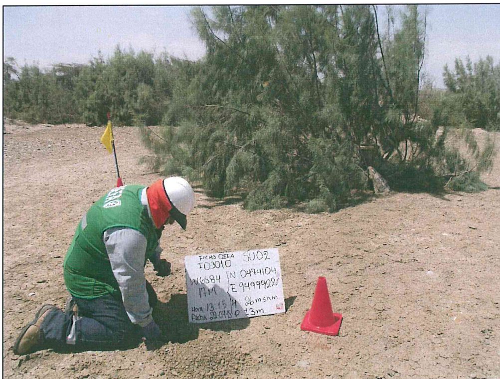
Fotografía N° 4. Toma de muestra de suelo en el punto F03010-SU02, ubicado a 4 m aproximadamente del Pozo T3203.
