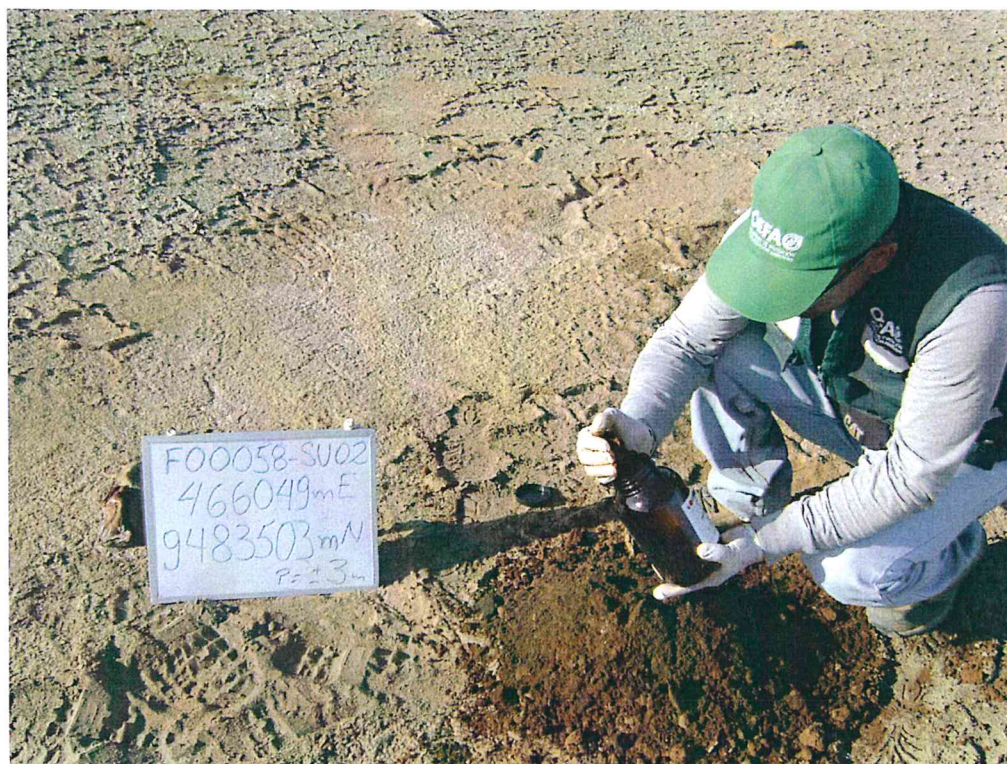
Fotografía N° 4. Toma de muestra de suelo en el punto F00058-SU02, ubicado a 9 m aproximadamente del Pozo T_838.
