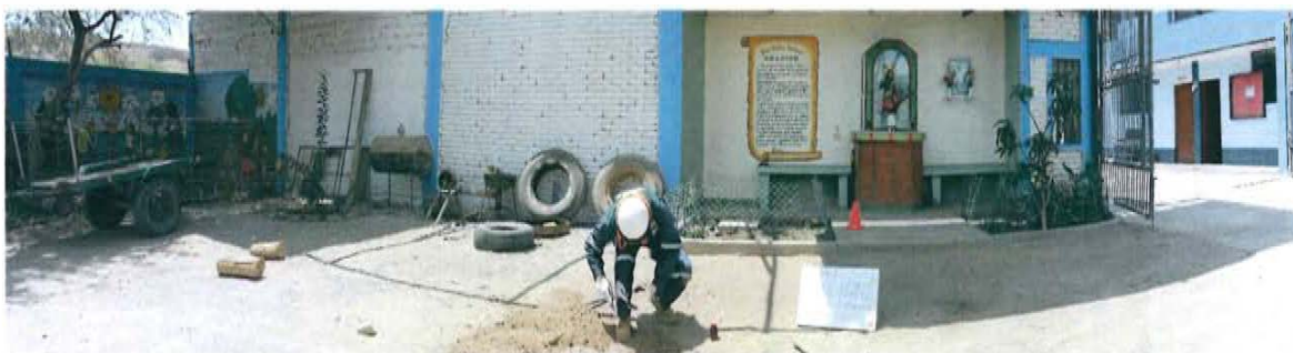
Fotografía N° 4. Toma de muestra de suelo en el punto F01767-SU02, ubicado a 5 m de la posible ubicación del pozo.
