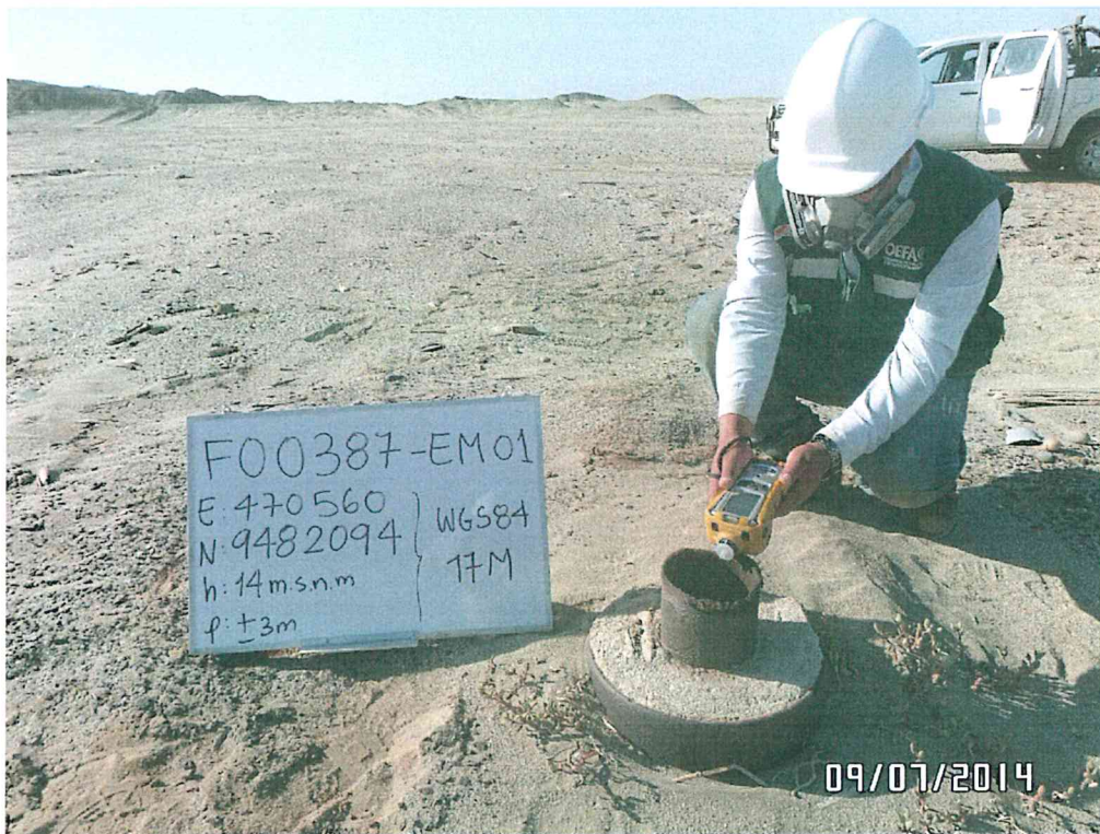
Fotografía N° 3. Medición en el punto F00387-EM01, ubicado en la fuente de emisión en boca del Pozo T1084.
