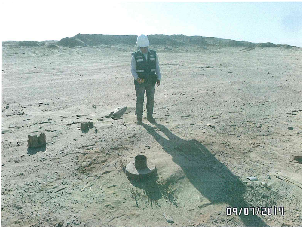
Fotografía N° 4. Mediciones en el punto F00387-VA01, se realizó en un recorrido en el área circundante alrededor del Pozo T1084 en un radio de 1 m, con una duración de 10 minutos.
