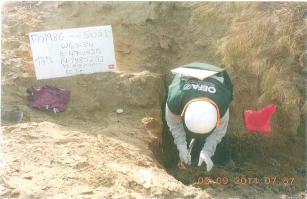
Fotografía N° 3. Toma de muestra de suelo en el punto F01986-SU01, ubicado a 2,1 m aproximadamente del Pozo T2670.
