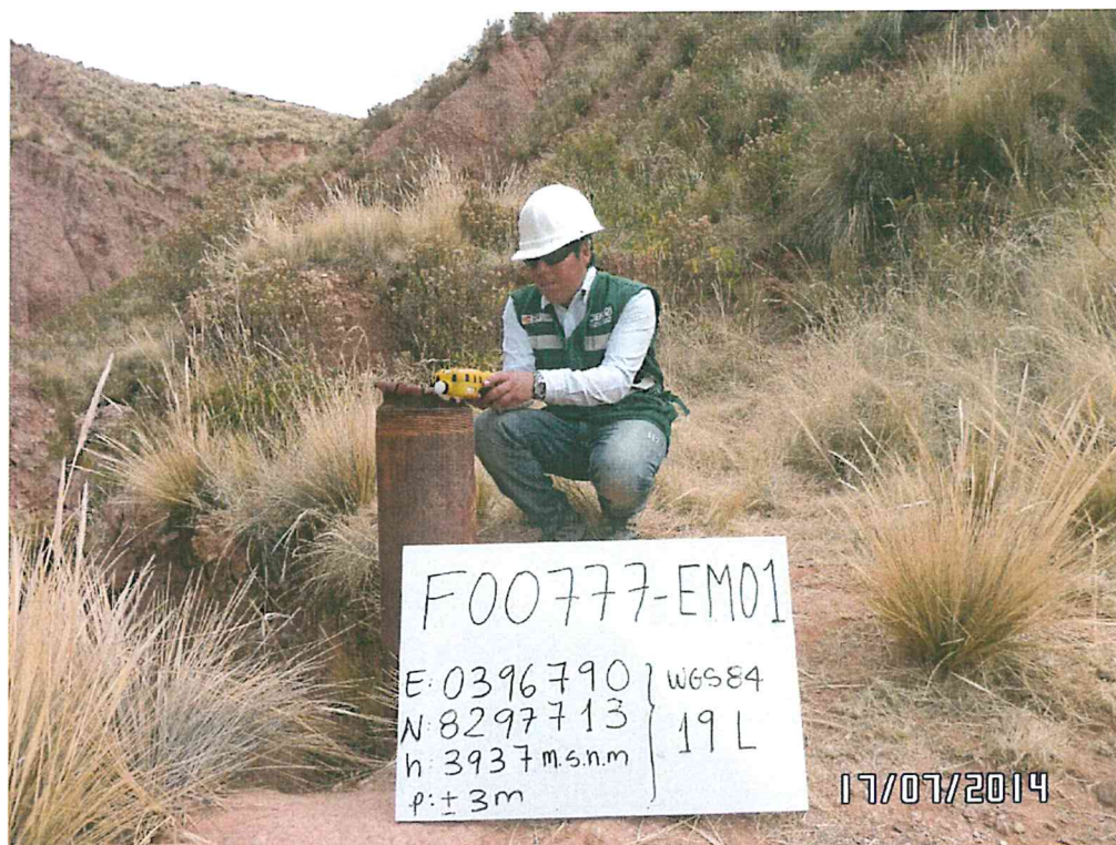
Fotografía N° 3. Medición en el punto F00777-EM01, ubicado en la fuente de emisión en boca del Pozo.
