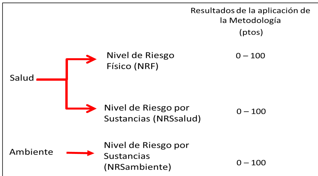
Figura 7.7. Indicadores de riesgos por presencia de peligros de tipo físico y por presencia de sustancias contaminantes
