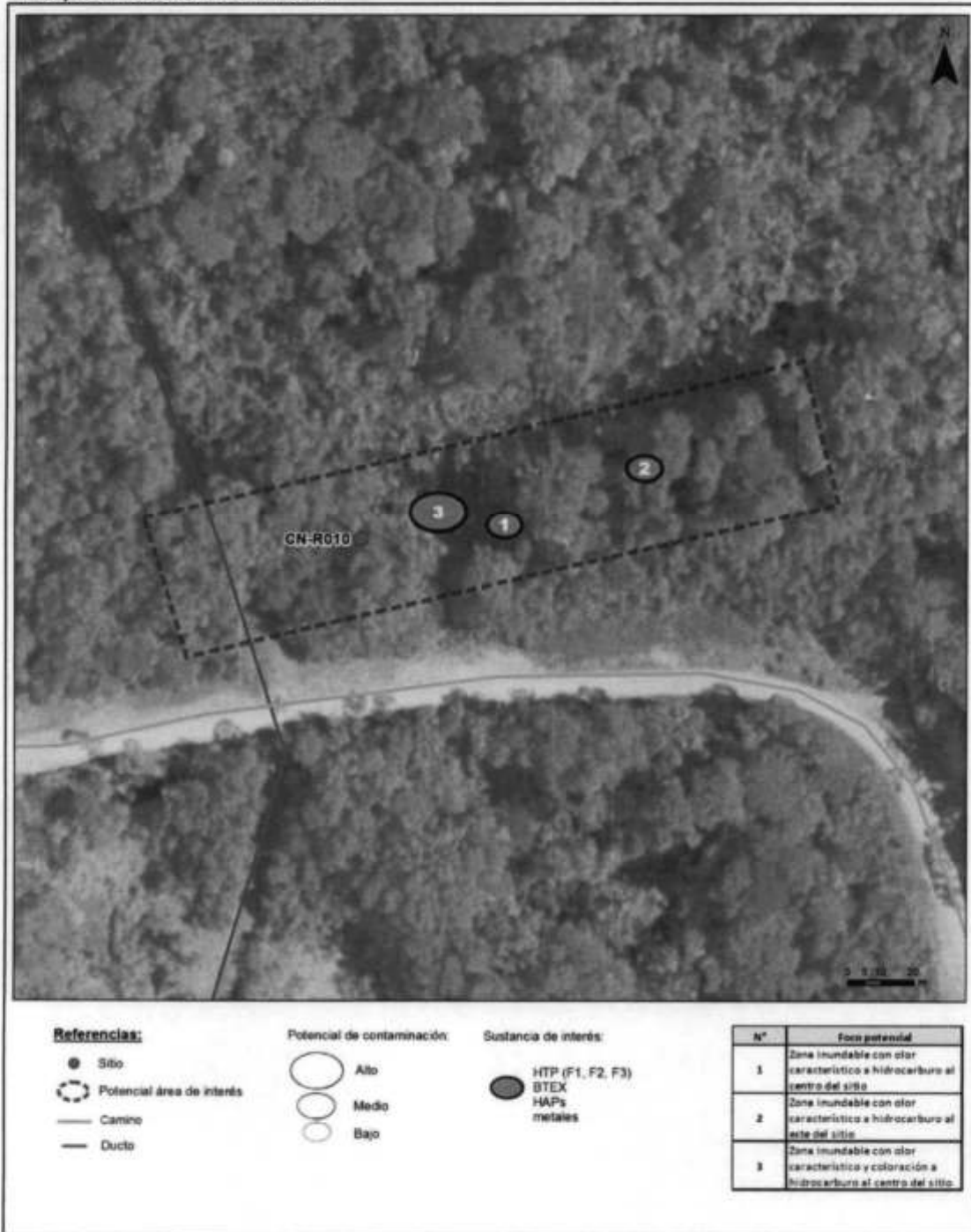
FIGURA 4 Focos potenciales de contaminación
