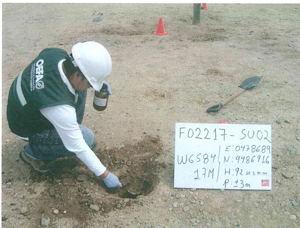
Fotografía N° 3. Toma de muestra de suelo en el punto F02217-SU02, ubicado a 5,8 m aproximadamente del Pozo T3613.
