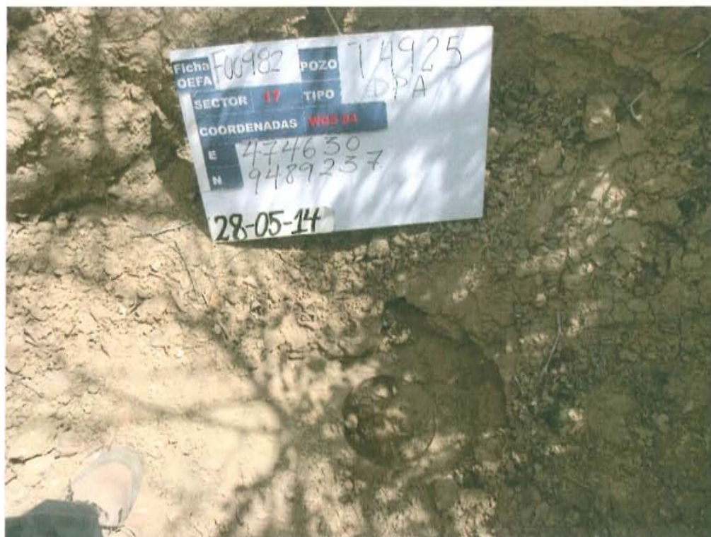
Fotografía N° 1. Casing que se encuentra a nivel del suelo en un hoyo de 1,40 m de profundidad.
