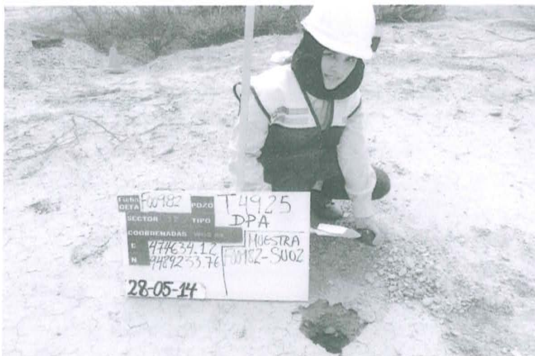
Fotografía N° 2. Toma de muestra de suelo en el punto F00982-SU02, ubicado a 6,0 m de distancia del Casing, Pozo T4925.
