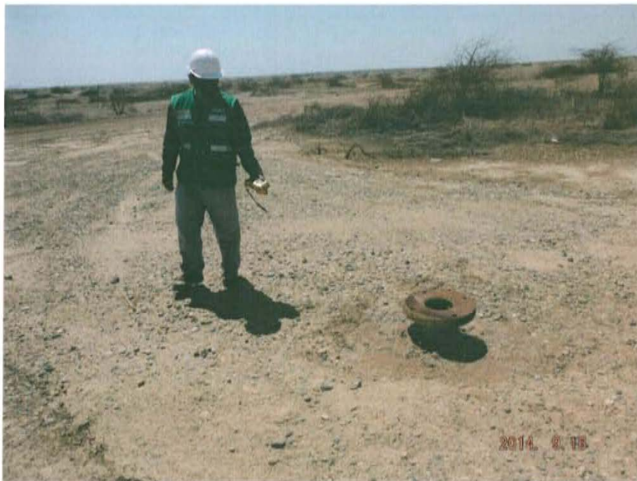
Fotografía N° 4. Medición de emisiones gaseosas fugitivas aproximadamente a 1 m alrededor del pozo.
