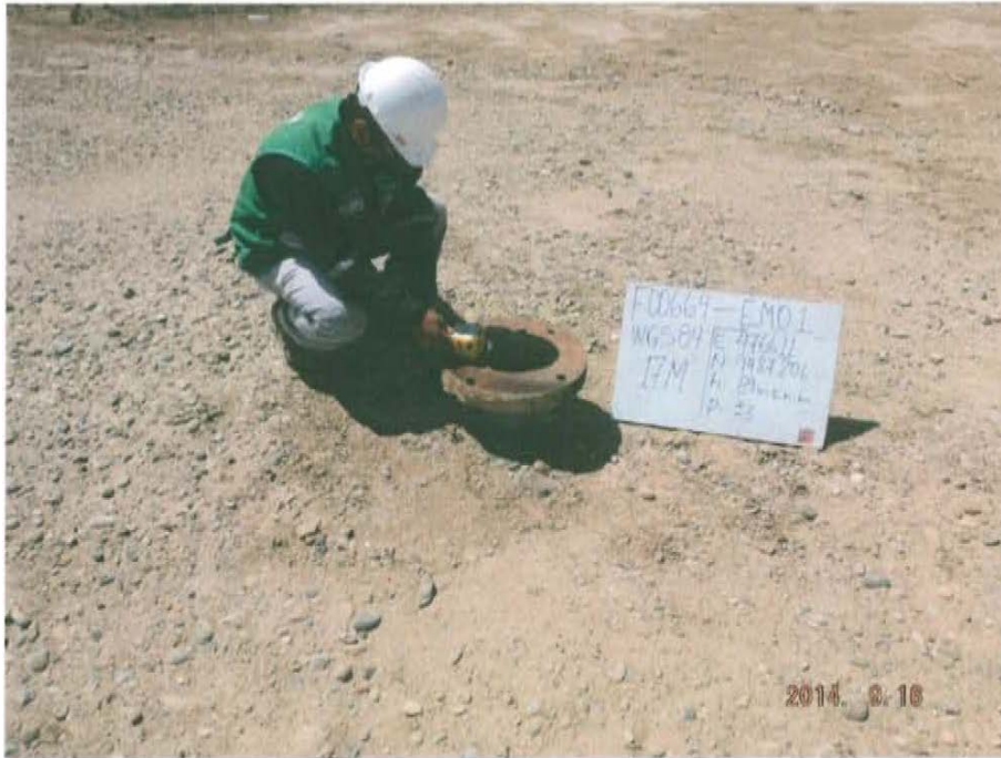
Fotografía N° 3. Medición de emisiones gaseosas fugitivas en la boca de pozo
