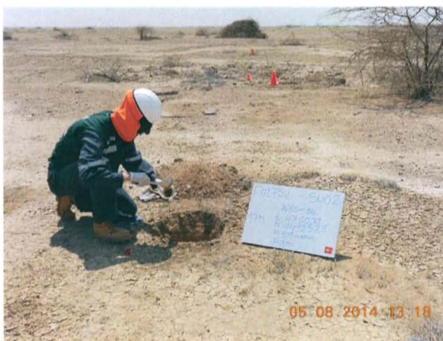
Fotografía N° 4. Toma de muestra de suelo en el punto (F01752-SU02), ubicado a 10,6 m del pozo T3480.
