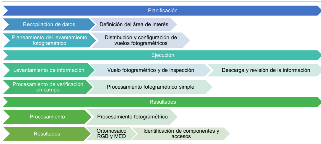
Figura 5.1. Esquema metodológico para la evaluación de la superficie terrestre en la UF PAM Ex UM Cleopatra.
