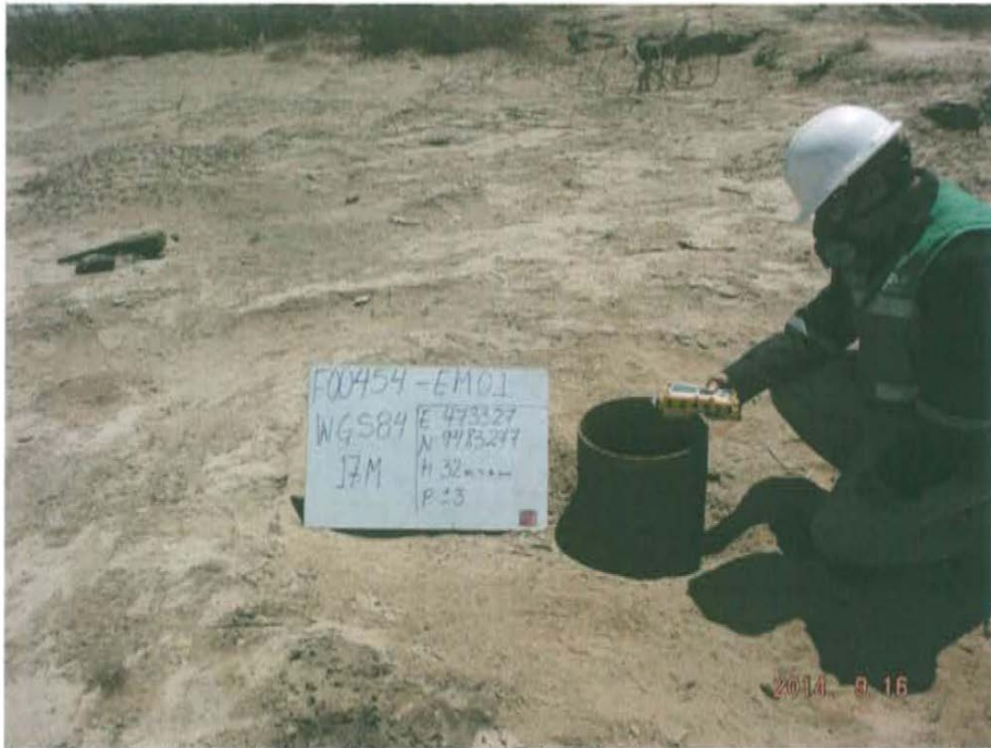
Fotografía N° 4. Vista de la evaluación de emisiones gaseosas a boca del pozo F00454.
