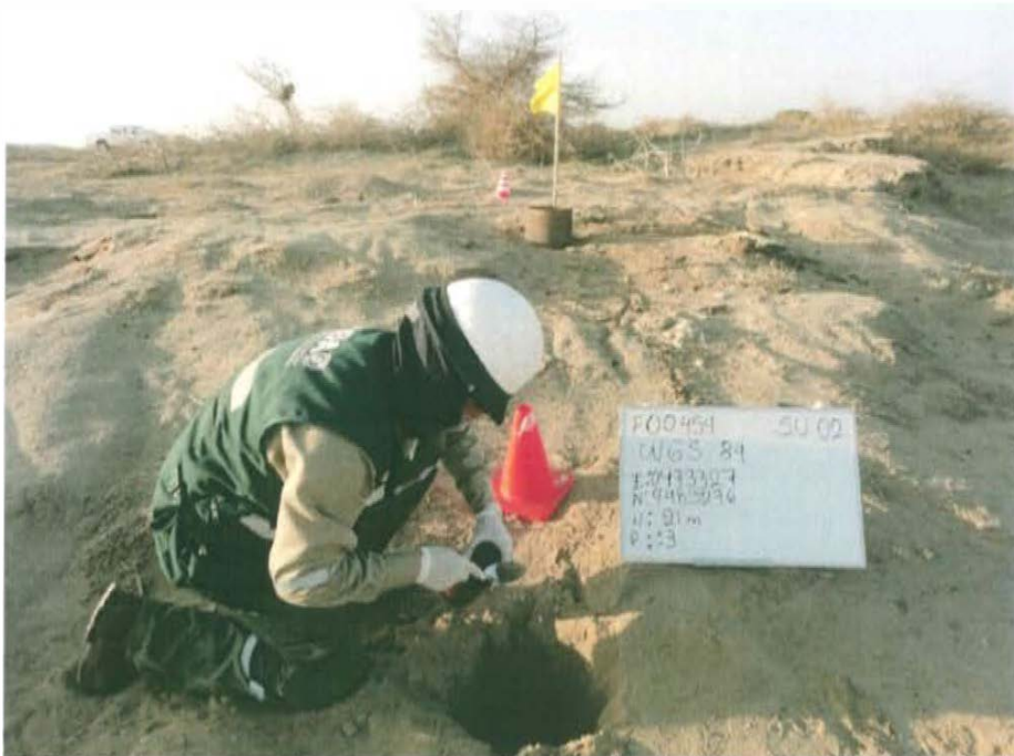
Fotografía N° 4. Vista de la toma de muestra de suelo realizado en el área de ubicación del pozo en el punto F00454-SU02.
