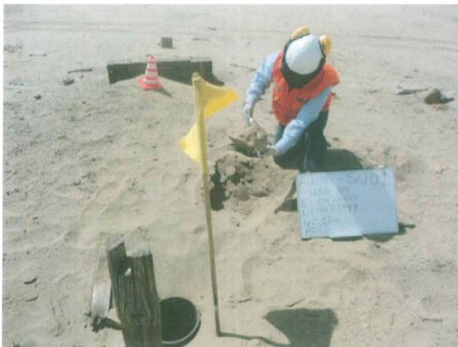
Fotografía N° 3. Toma de muestra de suelo F00385-SU01 a una distancia de 2 m del Pozo T1749.
