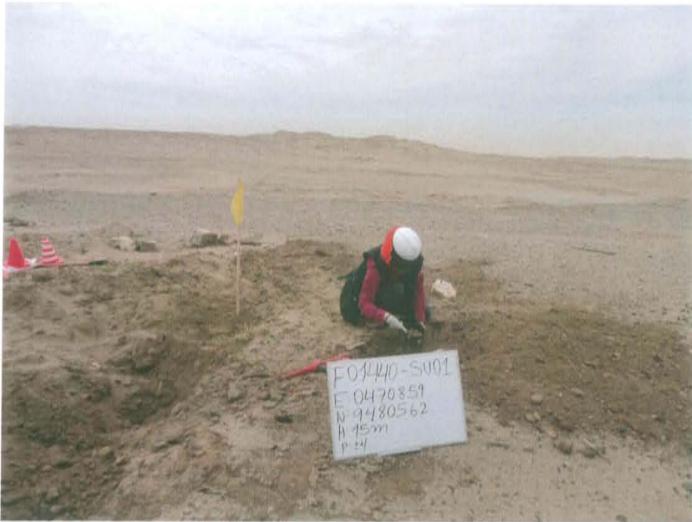
Fotografía N° 3. Toma de muestra de suelo en el punto F01440-SU01 a 1 m de distancia del pozo.
