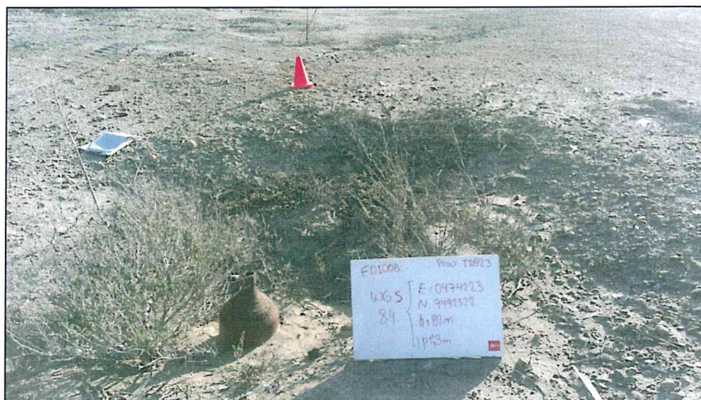
Fotografía N° 1. Pozo con código PERUPETRO T2823 inactivo mal abandonado sobresale una altura de 0,3 m sobre el nivel de la superficie.
