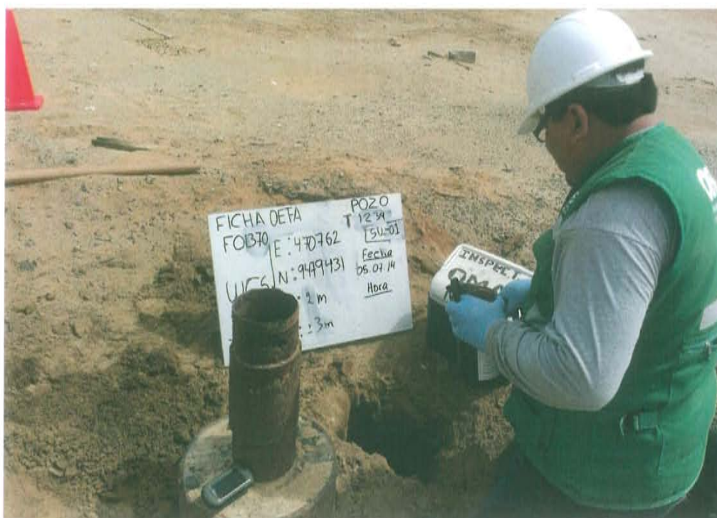
Fotografía N° 3. Primer punto de muestreo a 0,2 m de distancia del casing del pozo T1234, en el que se observa presencia de hidrocarburos.
