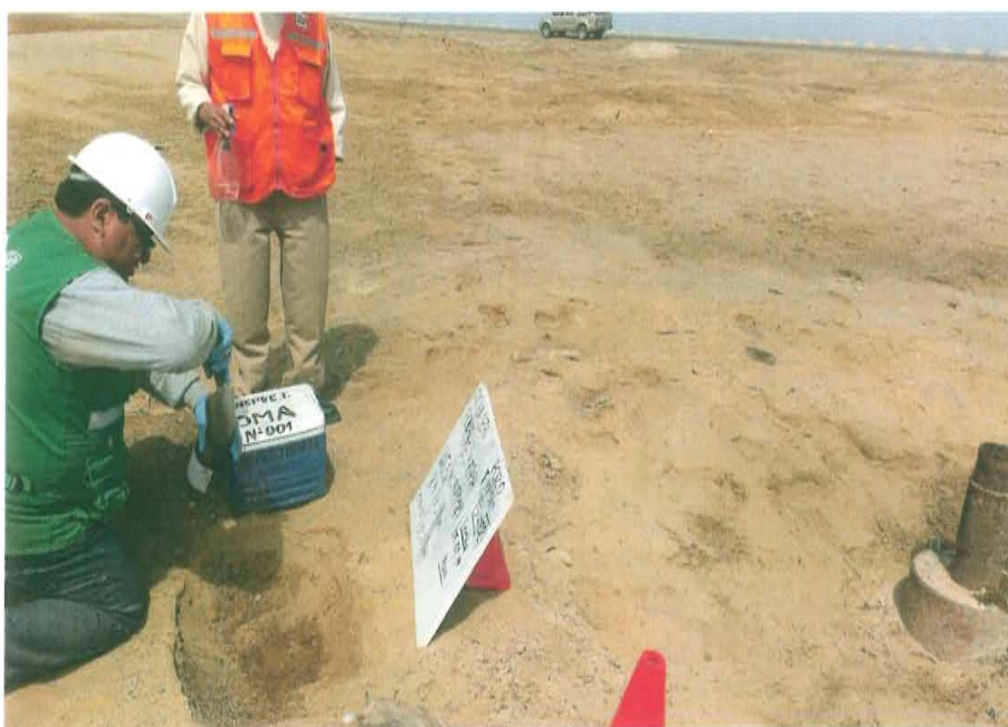
Fotografía N° 4. Segundo punto de muestreo a 2,1 m de distancia del pozo T1234, se muestreó en zona en la que se observa presencia de hidrocarburos.
