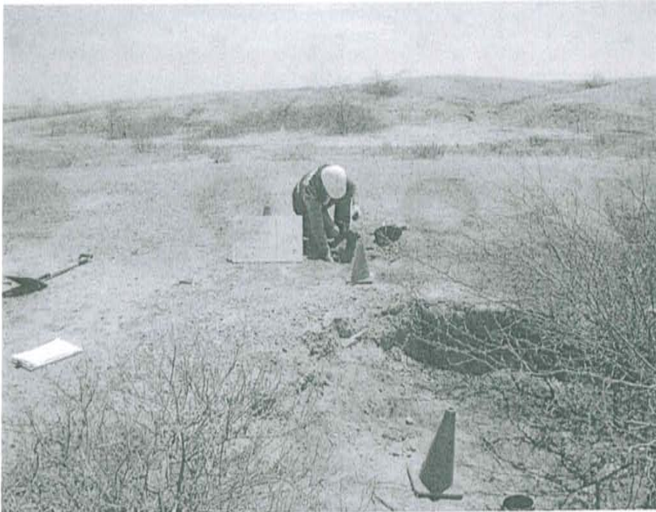
Fotografía N° 1. Toma de muestra de suelo en el punto F00927-SU01, ubicado a 4,20 m aproximadamente del Pozo T4139.
