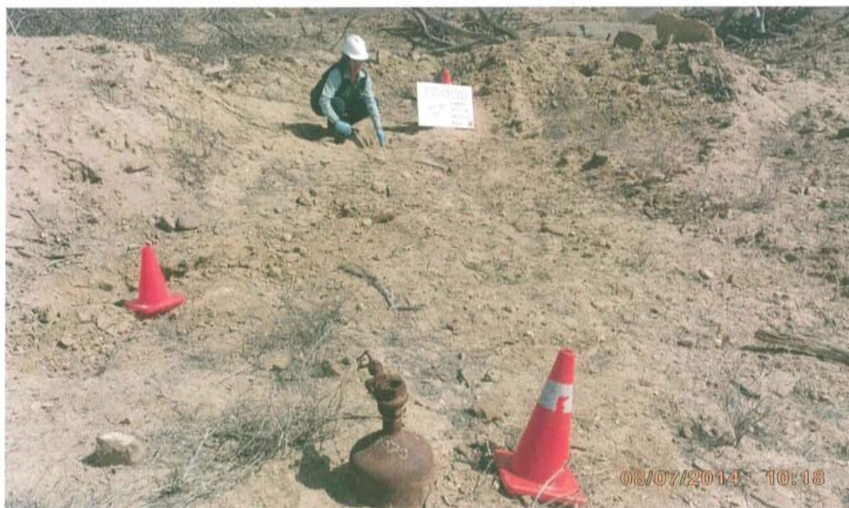
Fotografía N° 4. Toma de muestra de suelo en el punto F001269-SU02, ubicado a 4,80 m. aproximadamente del Pozo T4547.
