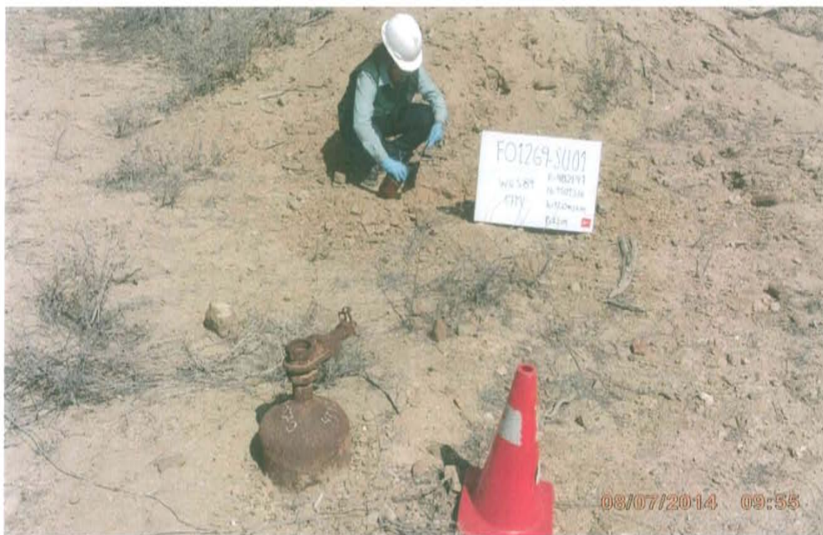
Fotografía N° 3. Toma de muestra de suelo en el punto F001269-SU01, ubicado a 1,20 m. aproximadamente del Pozo T4547.
