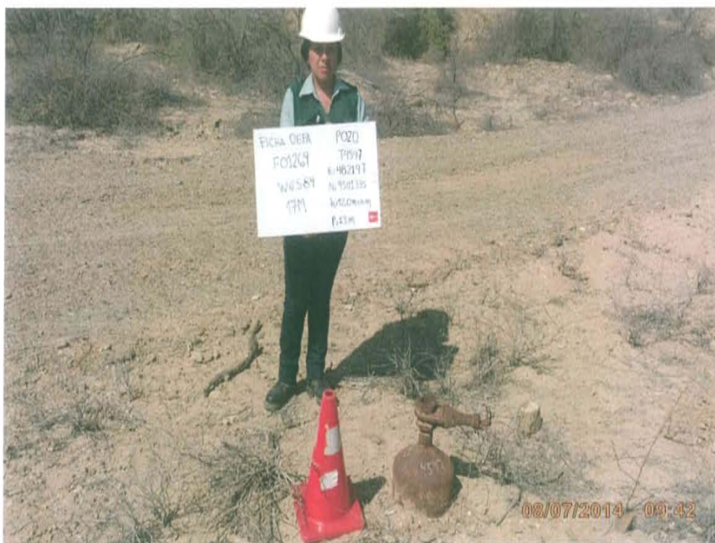
Fotografía N° 2. Vista del pozo, el casing de 11" de diámetro, que sobresale 0,50 m de la superficie del suelo. No se observa afloramiento de líquidos ni se perciben olores característicos a hidrocarburos, asimismo no se observa suelo impregnado con hidrocarburo y/o residuos industriales alrededor del pozo.
