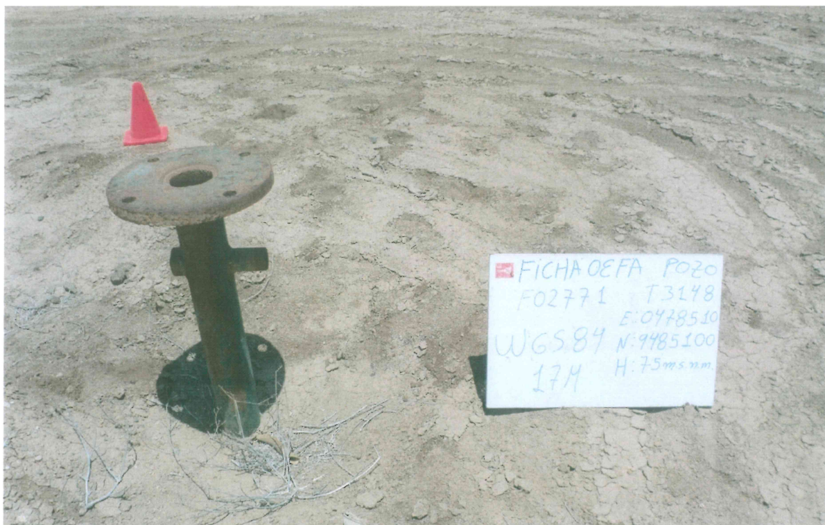
Fotografía N° 1. Pozo con código PERUPETRO T3148 y código Ficha OEFA F02771, se observa el casing con dos tuberías laterales y con cabezal compuesto por una brida que se encuentra abierta al ambiente.
