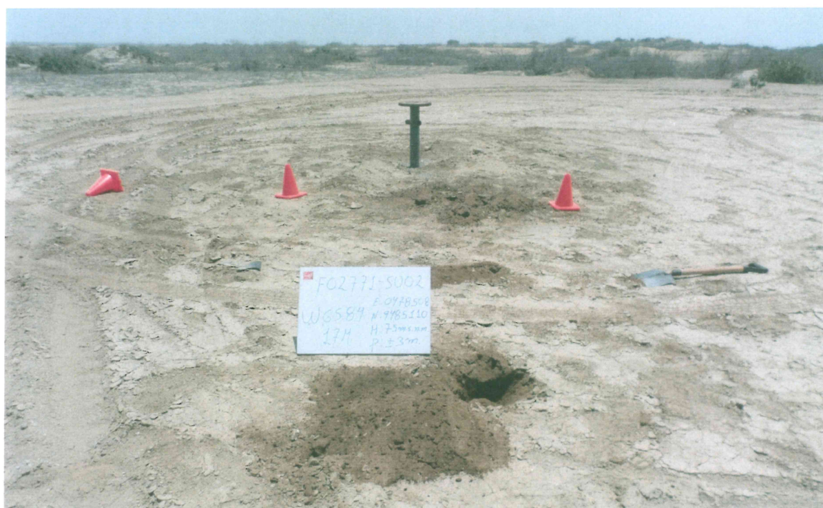
Fotografía N° 4. Toma de muestra de suelo en el punto F02771-SU02, ubicado a 5 m aproximadamente del Pozo T3148.
