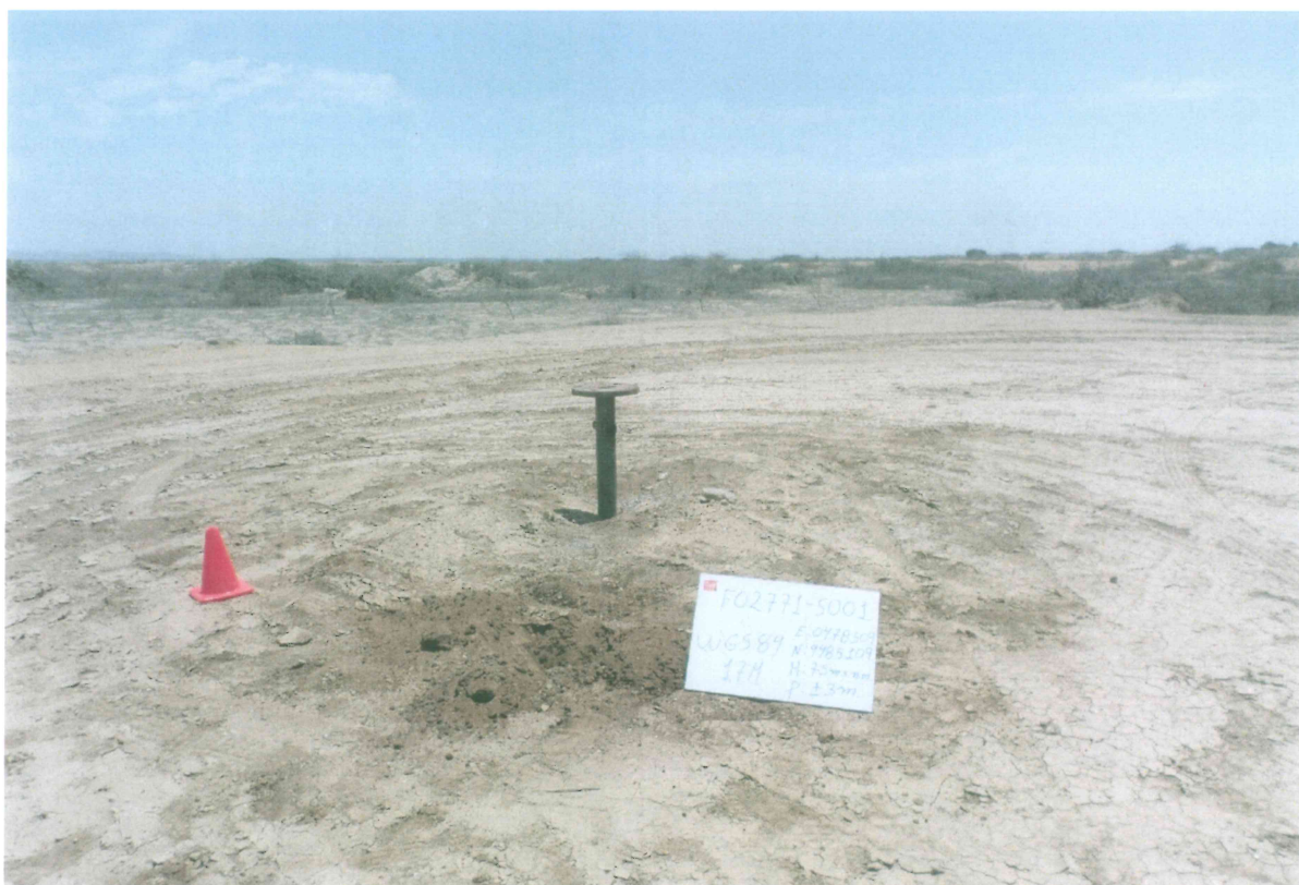
Fotografía N° 3. Toma de muestra de suelo en el punto F02771-SU01, ubicado a 2 m aproximadamente del Pozo T3148.
