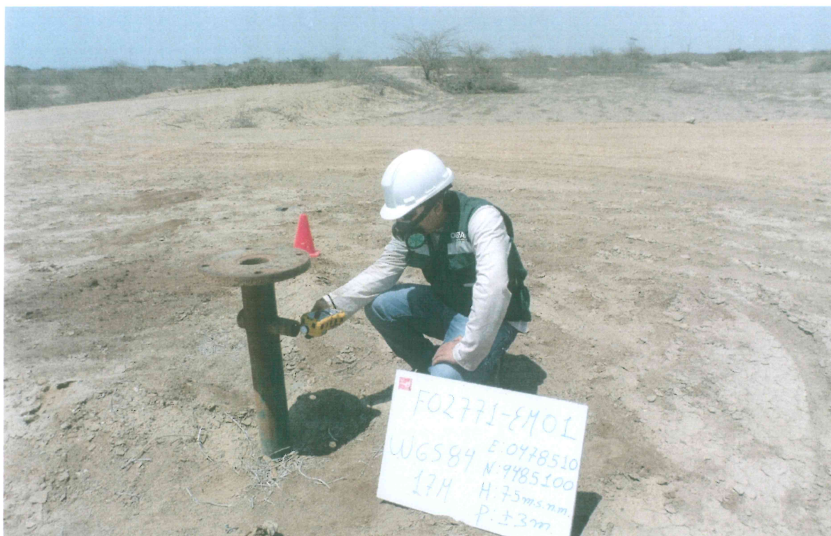
Fotografía N° 5. Medición en el punto F02771-EM01, ubicado en la fuente de emisión en boca del pozo T3148.
