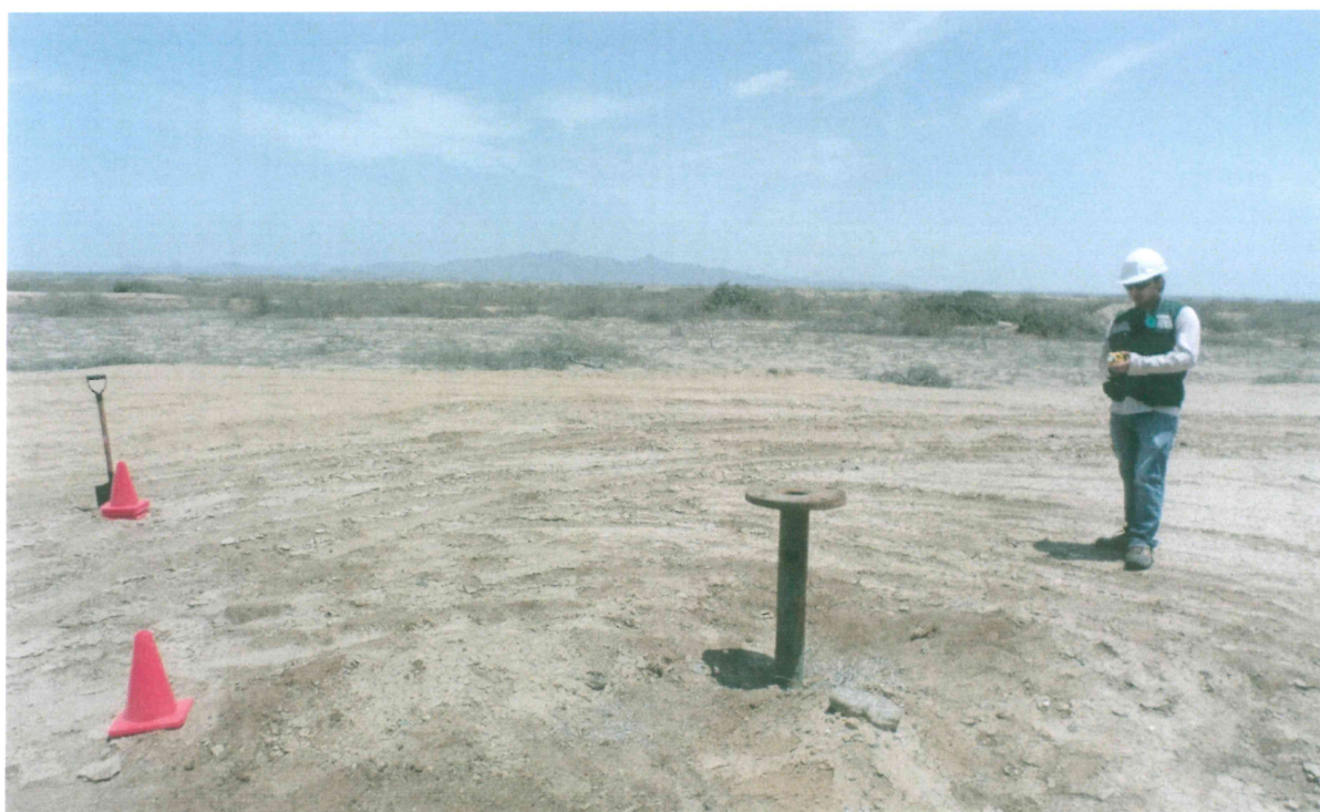
Fotografía N° 6. Mediciones en el punto F02771-VA01, se realizó un recorrido en el área circundante alrededor del pozo T3148, en un radio de 1 m aproximadamente y con una duración de 10 minutos.
