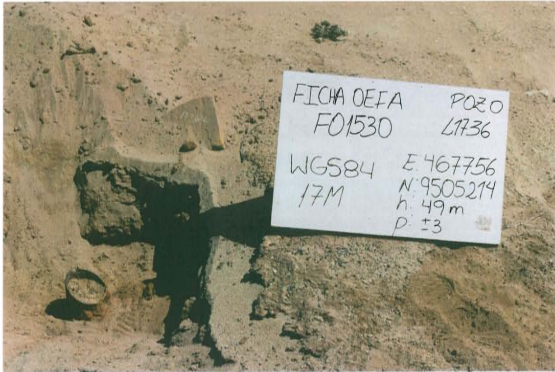
Fotografía N° 1. Identificación del pozo inactivo con código PERUPETRO L1736. Presenta casing cortado y corroído con arena en su interior.
