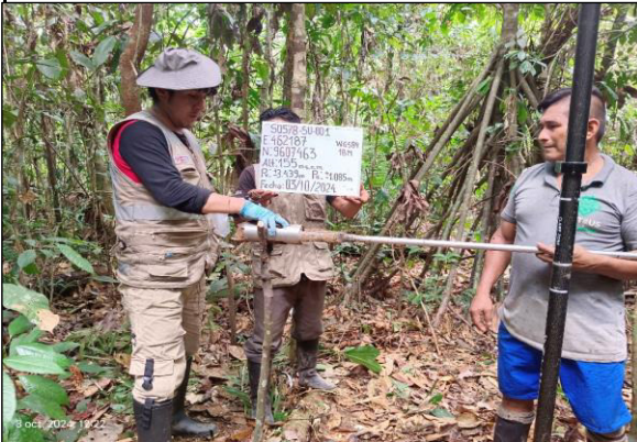
Toma de muestra de suelo en el punto con código S0578-SU-001, sin indicios organolépticos de hidrocarburos, la muestra fue tomado a una profundidad de entre 0,70-0,90 metros, rodeado de vegetación arbustiva y arbórea
