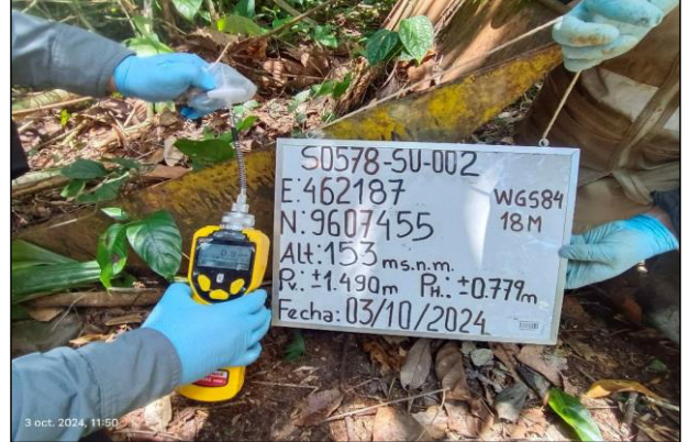
Toma de medición de compuestos orgánicos volátiles (COV) en la muestra de suelo con código S0578-SU-002, reportándose una lectura de 0,8 ppm.
