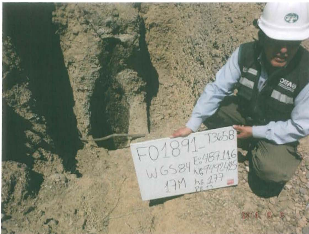
Fotografía N° 1. Pozo inactivo con código PERUPETRO T3658, no posee casing (tubería de revestimiento) y se encuentra dentro de hoyo de 5 m profundidad.
