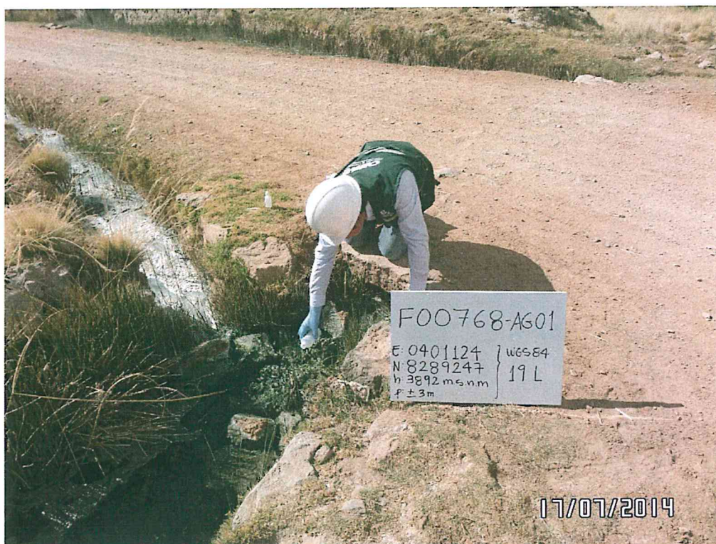
Fotografía N° 3. Toma de muestra de agua en el punto F00768-AG01, ubicado a 15.5 m aproximadamente del Pozo.
