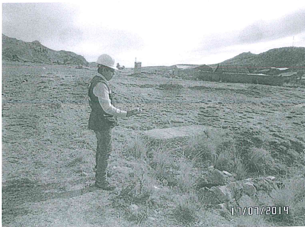
Fotografía N° 2. Mediciones en el F00759-VA01, se realizó en un recorrido en el área circundante alrededor del Pozo en un radio de 1 m, con una duración de 10 minutos.
