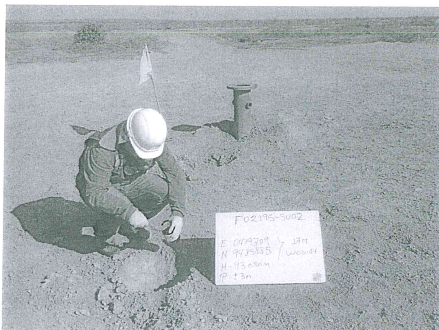
Fotografía N° 2. Toma de muestra de suelo en el punto F02195-SU02, ubicado a 3 m aproximadamente del Pozo T2195.
