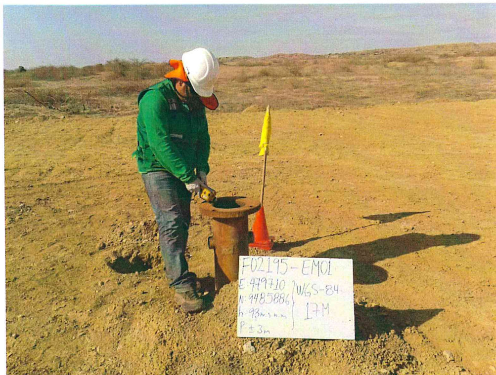
Fotografía N° 4. Vista de la medición de emisiones en el punto F02195-EM01, ubicado en boca del pozo T2163.
