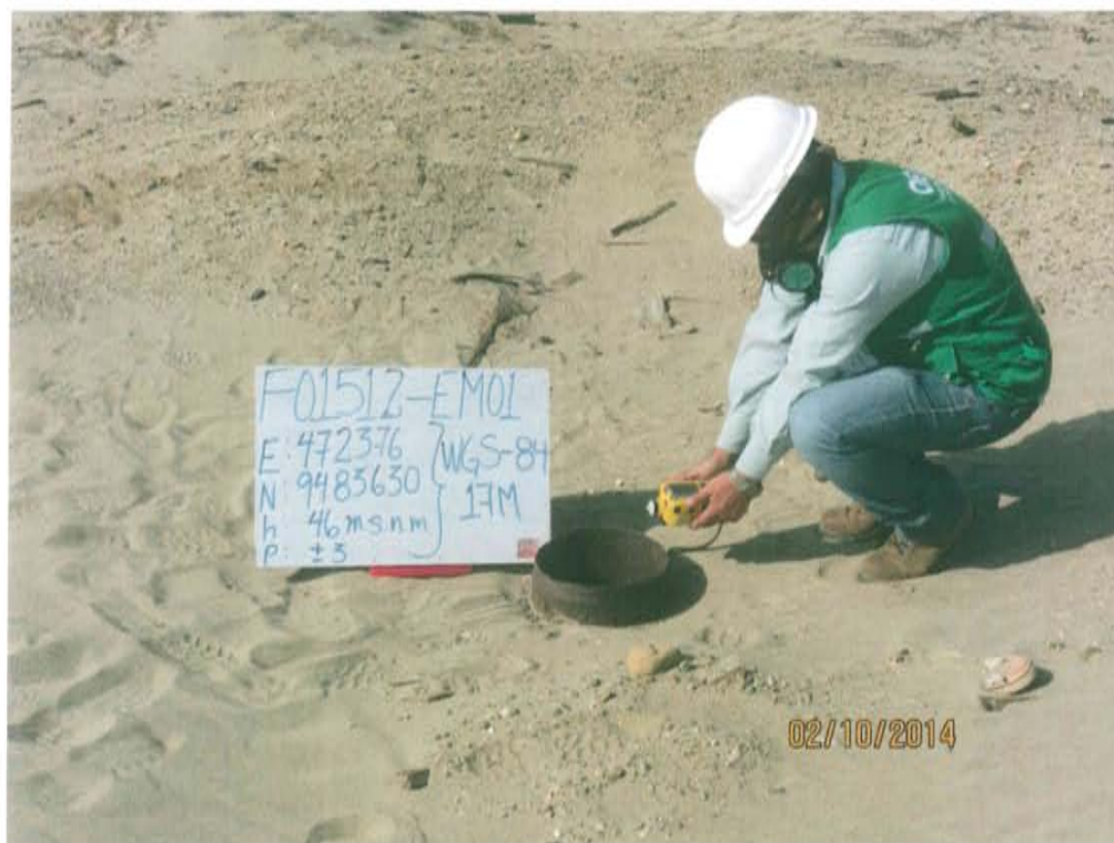
Fotografía N° 4. Medición en el punto F01512-EM01, ubicado en la fuente de emisión en boca del Pozo T2185.
