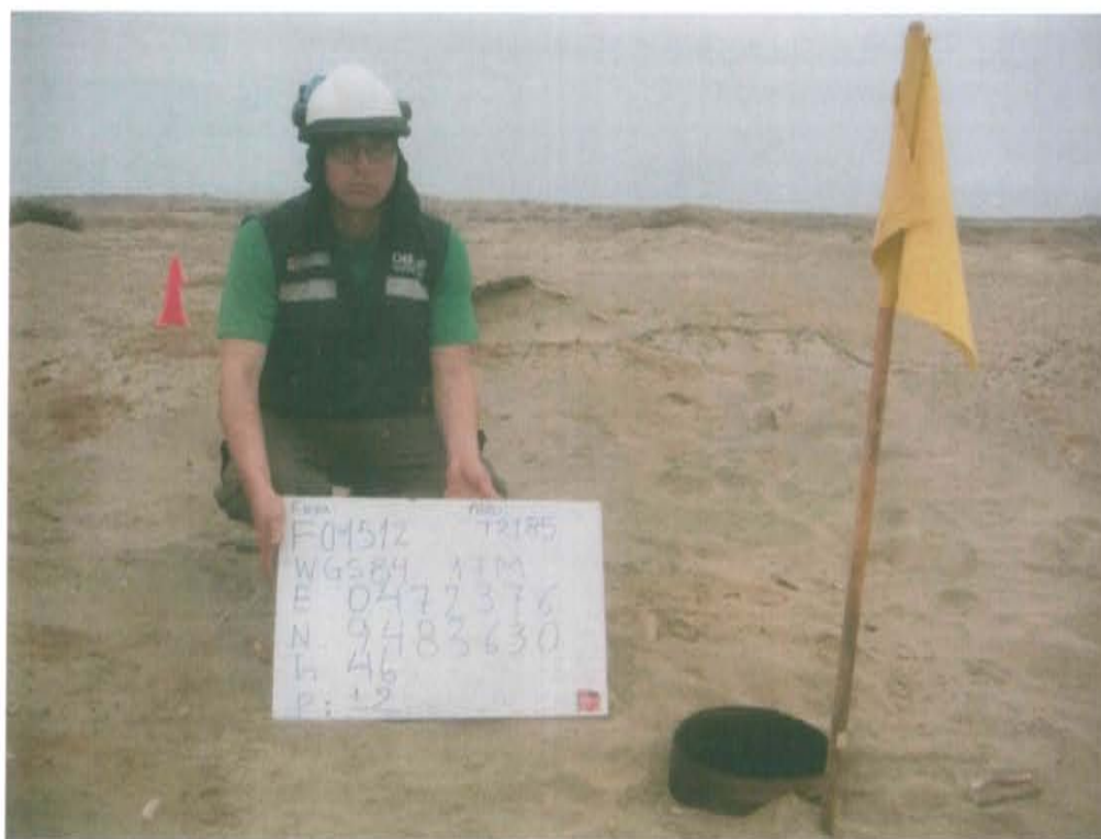
Fotografía N° 1. Identificación del pozo inactivo con código PERUPETRO T2185. Presenta casing abierto al medio ambiente.
