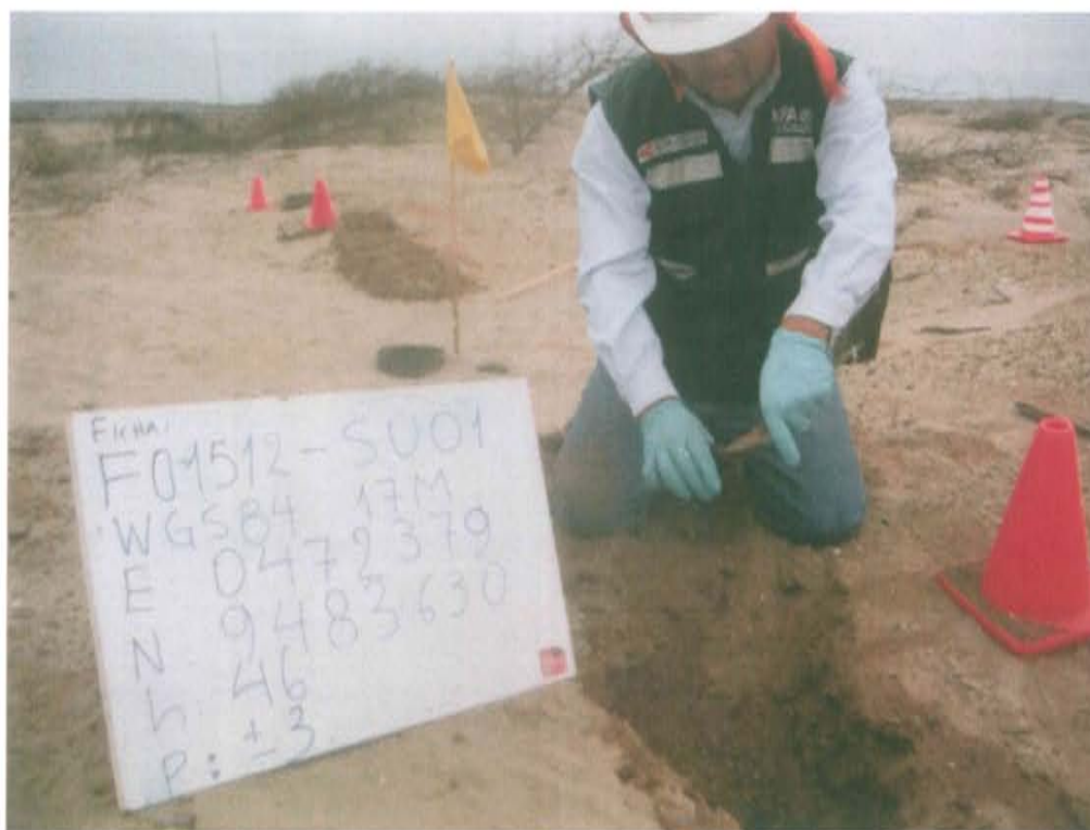
Fotografía N° 3. Toma de muestra de suelo en el punto F01512-SU01, ubicado aproximadamente a 3 m al oeste del Pozo T2185.
