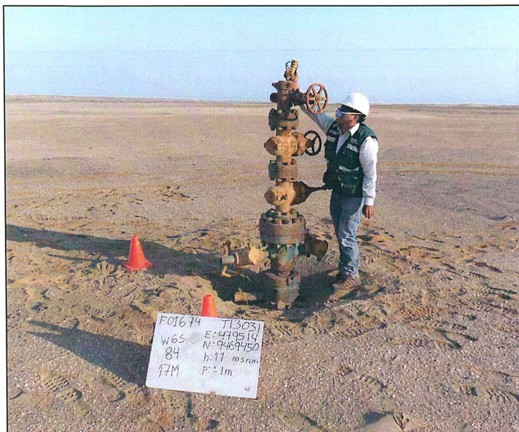
Fotografía N° 4. Medición de emisiones gaseosas fugitivas en boca de pozo T13031.
