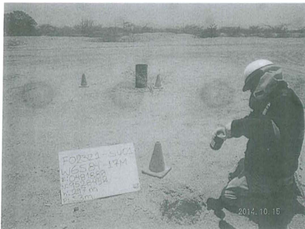
Fotografía N° 1. Toma de muestra de suelo en el punto F02321-SU01, ubicado a 3 m aproximadamente del Pozo A_328
