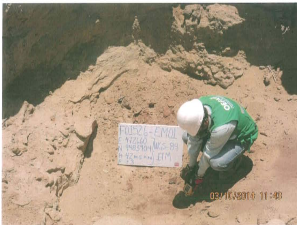
Fotografía N° 4. Medición en el punto F01526-EM01, ubicado en la posible fuente de emisión que sería en boca del Pozo T1752.
