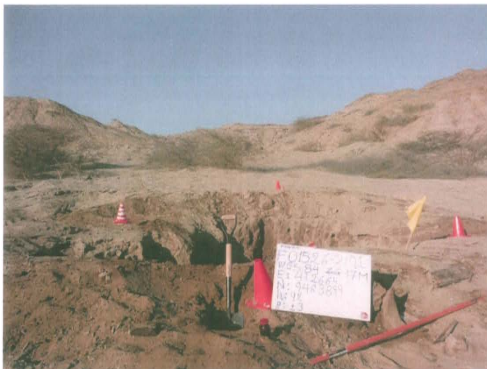
Fotografía N° 3. Toma de muestra de suelo en el punto F01526-SU01, ubicado aproximadamente a 3 m al oeste del Pozo T1752.
