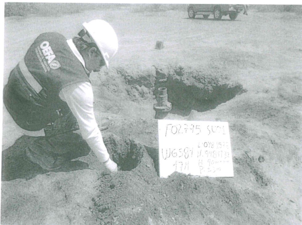
Fotografía N° 1. Toma de muestra de suelo en el punto F02795-SU01, ubicado a 2,7 m aproximadamente del pozo T4632.
