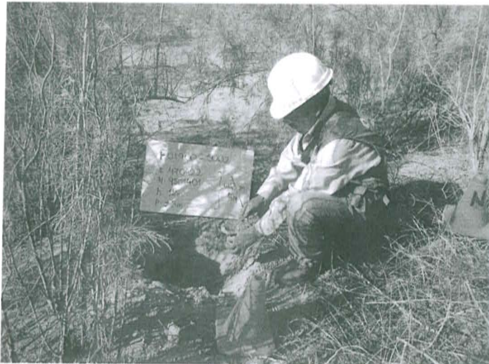
Fotografía N° 2. Toma de muestra de suelo en el punto F01900-SU02 ubicado a 4 m al norte del Pozo T4808.
