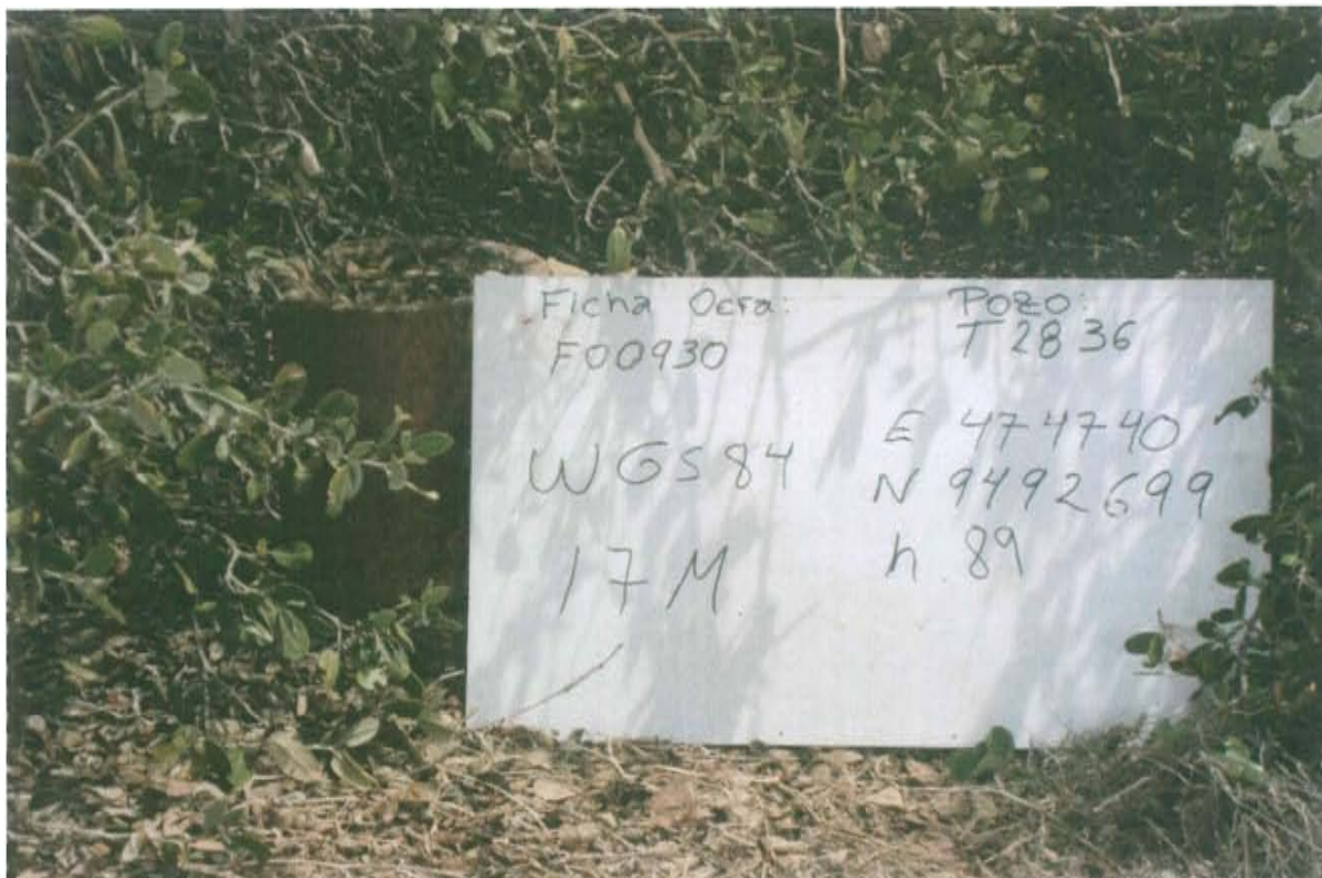
Fotografía N° 01.- Pozo con código PERUPETRO T2836 y con código Ficha OEFA F00930, se observa el casing del pozo sin cabezal o alguna válvula, por lo que se encontraría expuesto al ambiente.
