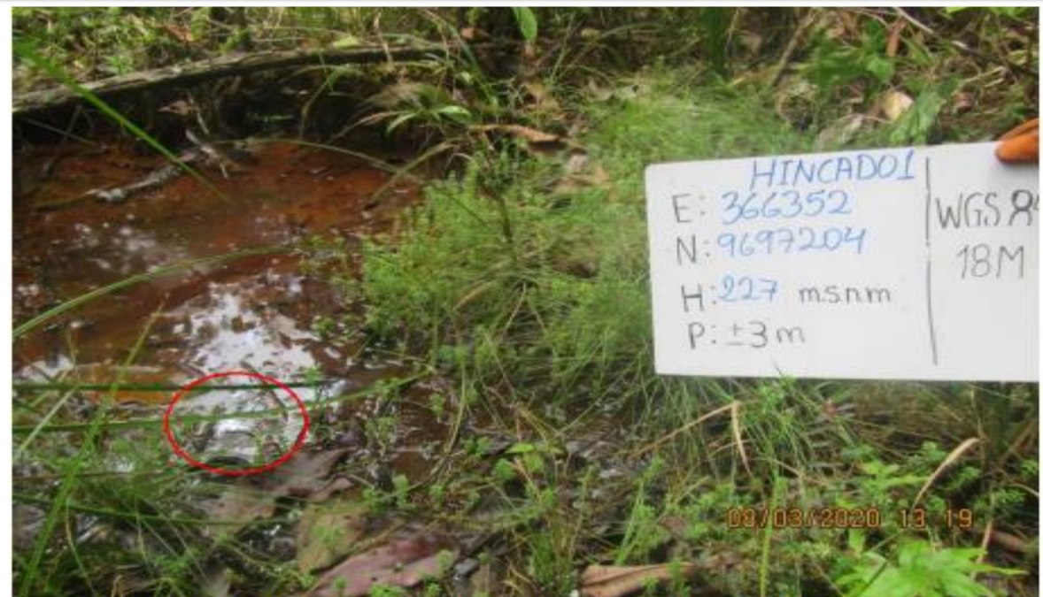
En el hincado 1 del sitio S0410 se percibió suelo saturado con afectación organoléptica por hidrocarburos, se percibió iridiscencia en el agua libre del suelo y olor a hidrocarburos luego de realizar el hincado hasta 0,6 m de profundidad.
