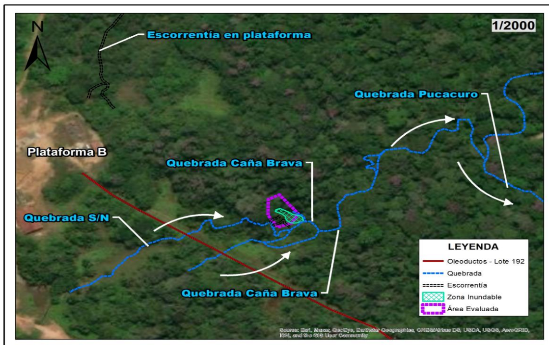
Figura 9.3. Dirección estimada de la escorrentía superficial en el sitio S0410 y alrededores.
