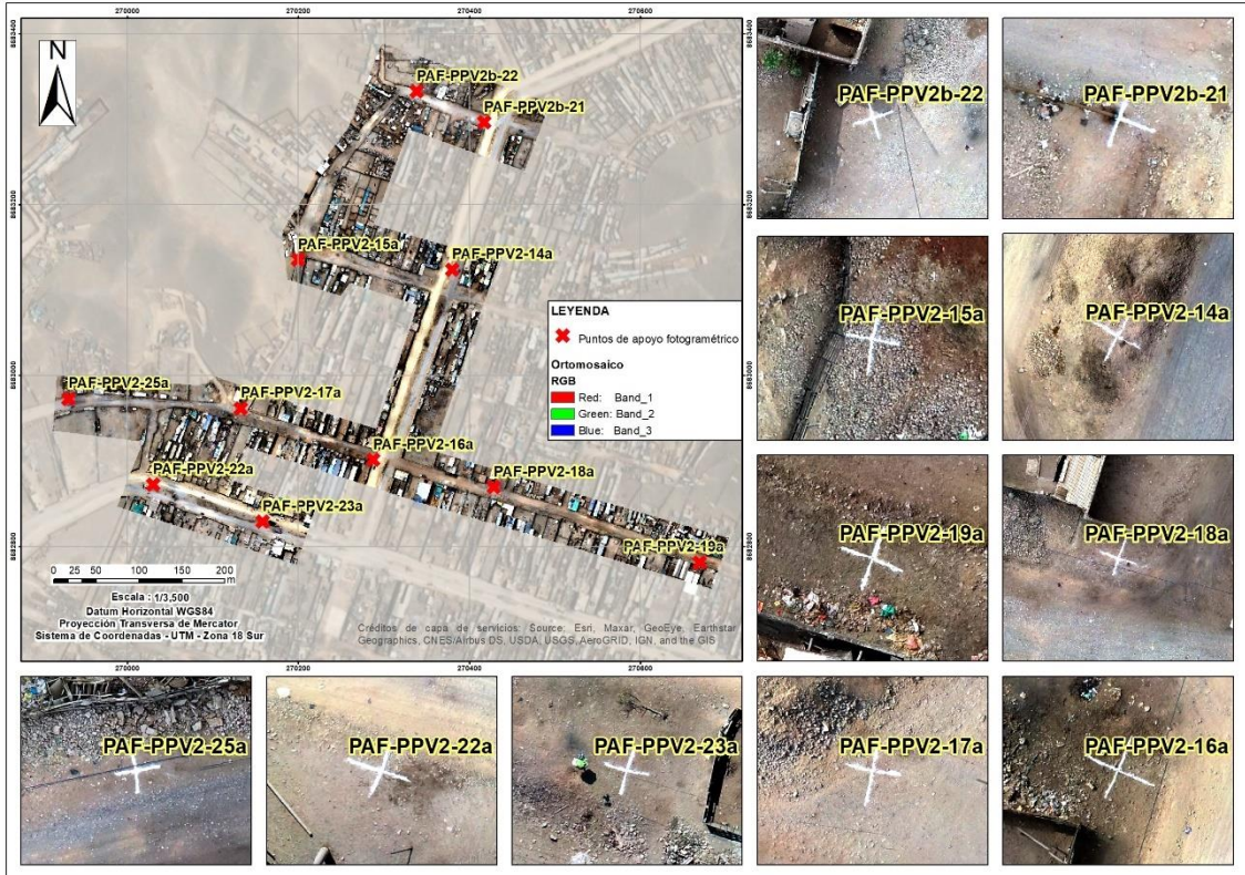
Figura 5.2.6. Ubicación de los PAF para identificación de zonas de excretas y/o purines en el bloque PPV2-05 de la zona norte de la UF Parque Porcino
