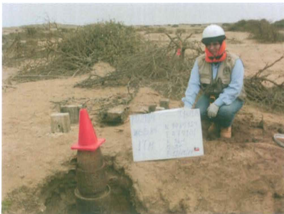
Fotografía N° 2. Pozo T1471A ubicado dentro de un hoyo sobresaliendo unos 0,48 m. presenta emisiones gaseosas.
