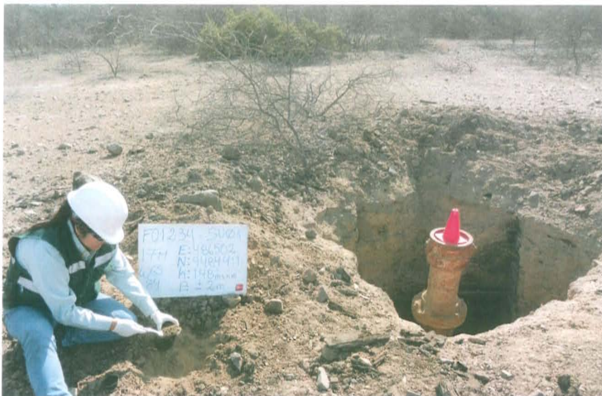
Fotografía N° 03.- Toma de muestra de suelo en el punto F01234-SU01, ubicado a 2,7 m aproximadamente del Pozo T2427.
