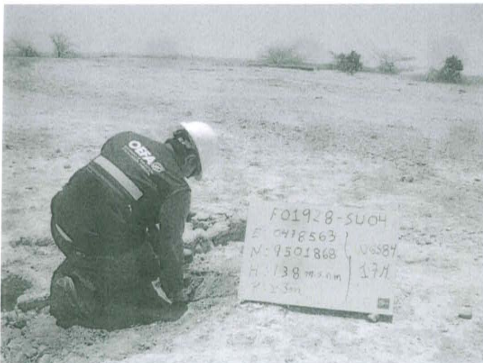
Fotografía N° 4. Toma de muestra de suelo en el punto F01928-SU04, ubicado a 29 m aproximadamente del Pozo T5417.
